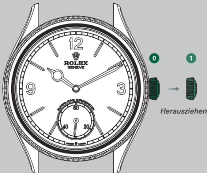
Bitte bringen Sie die Aufzugskrone nach jedem Bedienvorgang wieder in *Position 0*. Die Aufzugskrone darf in keinem Fall unter Wasser betätigt werden.
