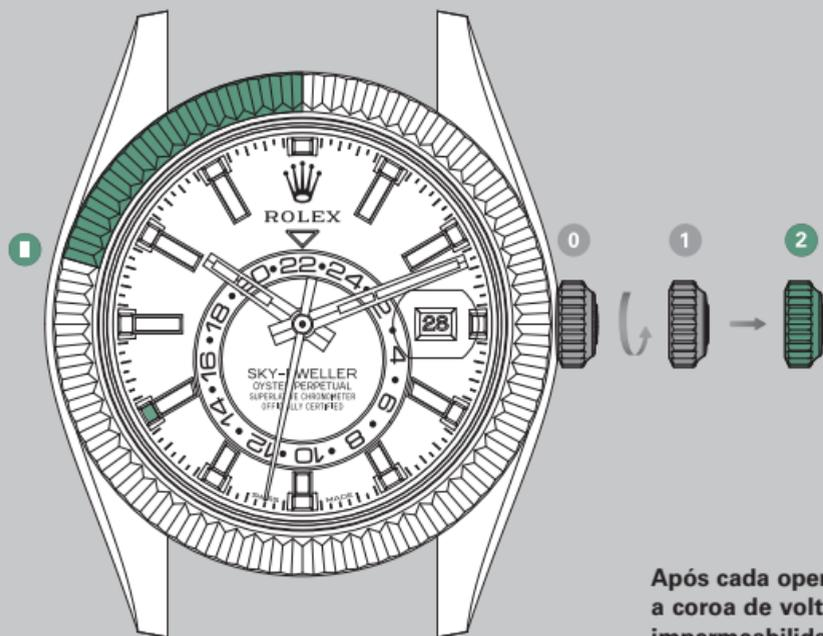
Após cada operação, aperte cuidadosamente a coroa de volta à caixa para garantir a impermeabilidade. Coloque a coroa de volta na *posição 1* e, em seguida, aplique uma leve pressão para rosqueá-la em sentido horário na direção da caixa. A coroa nunca deve ser manipulada quando o relógio estiver na água.
