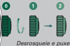
Após cada operação, aperte cuidadosamente a coroa de volta à caixa para garantir a impermeabilidade. Colocar a coroa de volta na *posição 1* e, em seguida, aplicar uma leve pressão para rosqueá-la em sentido horário na direção da caixa. A coroa nunca deve ser manipulada quando o relógio estiver na água.
