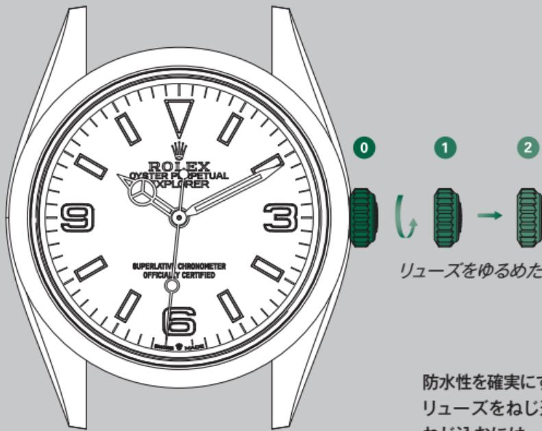
防水性を確実にするため、リューズ操作後は、必ず十分にリューズをねじ込んでください。リューズをケースにねじ込むには、1の位置までリューズを戻してください。その後リューズをケースに押し込みながら、時計回りに最後までねじ込んでください。水中でのリューズの操作は絶対にしないでください。
