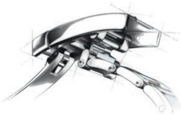
为了确保佩戴舒适，劳力士特别研制了易调链节延展系统。其专利设计包含可向外拉伸或向内摺叠的链节，无需使用任何工具，便可延长或缩短表带约 5 毫米。
