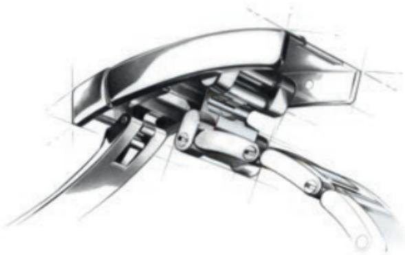
Con el fin de garantizar una comodidad óptima para el usuario, Rolex ha creado el sistema de extensión rápida Easylink. Este sistema exclusivo, que consiste en un eslabón que se puede desplegar o replegar sobre sí mismo, permite ajustar la longitud del brazalete en aproximadamente 5 mm, sin necesidad de herramienta alguna.
