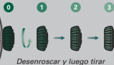
Después de cada manipulación, volver a enroscar con cuidado la corona a la caja para garantizar la hermeticidad. Colocarla en *posición 1*; a continuación, ejercer una ligera presión mientras se enrosca a la caja girándola en el sentido de las agujas. La corona en ningún caso debe manipularse bajo el agua.
