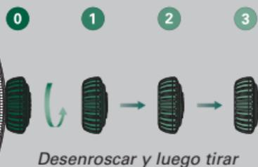
Después de cada manipulación, volver a enroscar con cuidado la corona a la caja para garantizar la hermeticidad. Colocarla en *posición 1*; a continuación, ejercer una ligera presión mientras se enrosca a la caja girándola en el sentido de las agujas. La corona en ningún caso debe manipularse bajo el agua.
