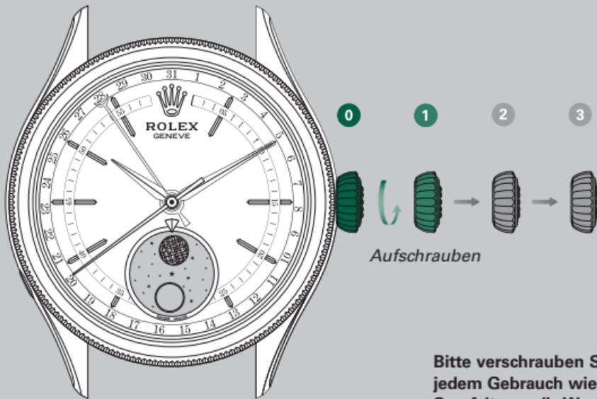
Bitte verschrauben Sie die Aufzugskrone nach jedem Gebrauch wieder fest und mit besonderer Sorgfalt, um die Wasserdichtheit der Armbanduhr zu gewährleisten. Bringen Sie die Aufzugskrone in *Position 1*. Danach drücken Sie sie bei gleichzeitigem Drehen im Uhrzeigersinn leicht gegen das Gehäuse. Die Aufzugskrone darf in keinem Fall unter Wasser betätigt werden.
