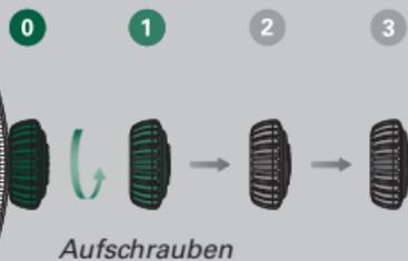
Bitte verschrauben Sie die Aufzugskrone nach jedem Gebrauch wieder fest und mit besonderer Sorgfalt, um die Wasserdichtheit der Armbanduhr zu gewährleisten. Bringen Sie die Aufzugskrone in *Position 1*. Danach drücken Sie sie bei gleichzeitigem Drehen im Uhrzeigersinn leicht gegen das Gehäuse. Die Aufzugskrone darf in keinem Fall unter Wasser betätigt werden.
